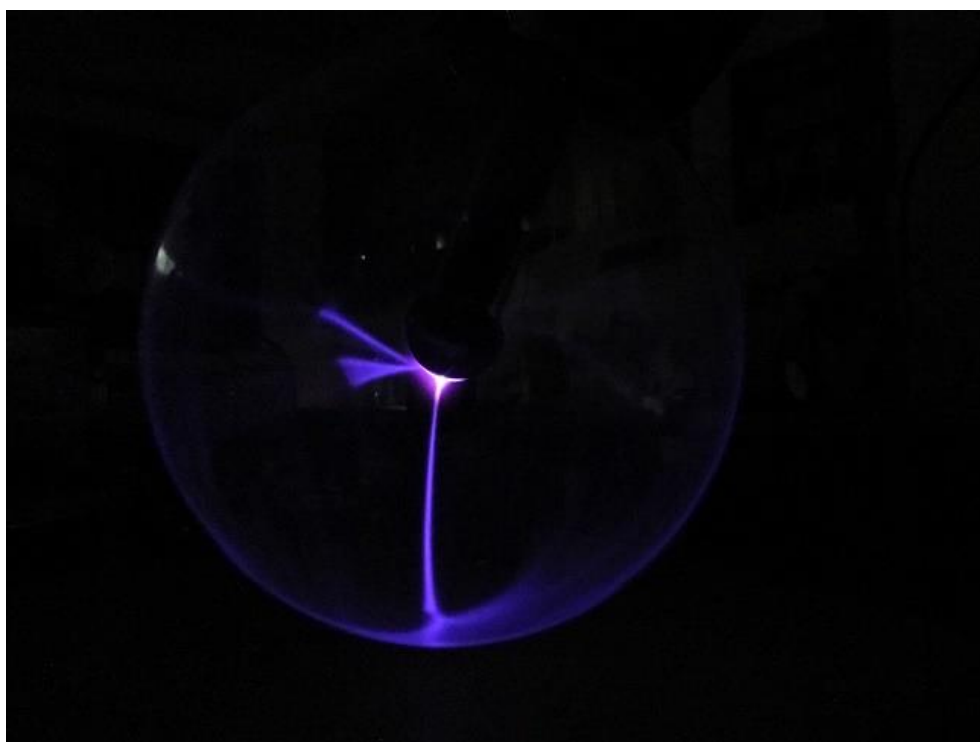
Slika 4.9.2. Plazma kod tlaka od četrdesetak milibara punjena zrakom
