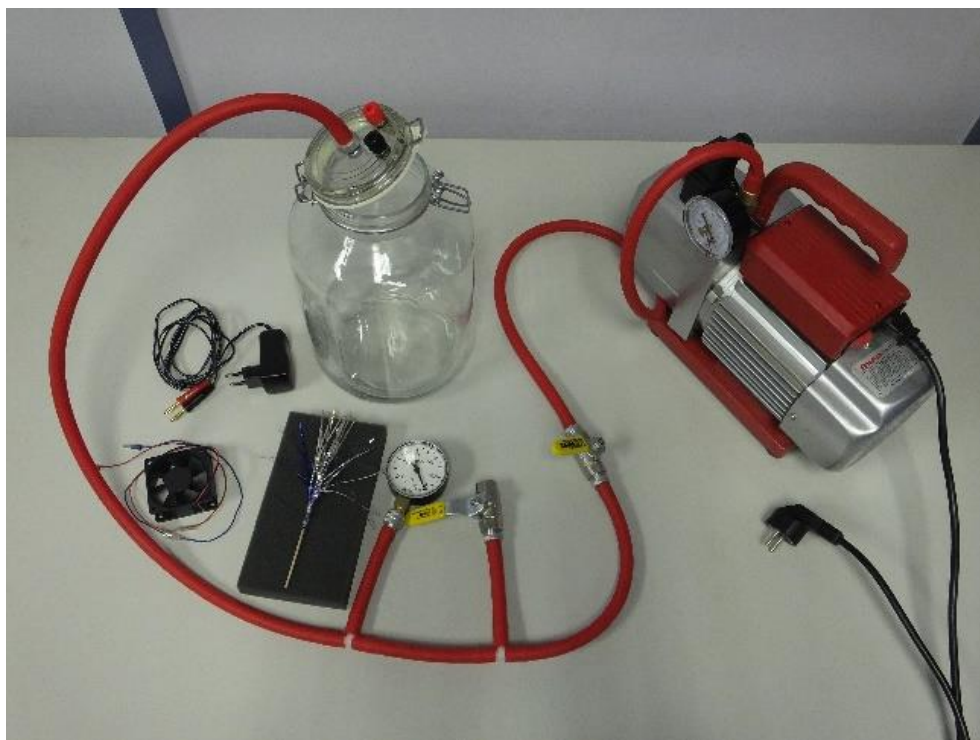
Slika 4.2.1. Eksperimentalni postav za vježbu vjetar u vakuumu
