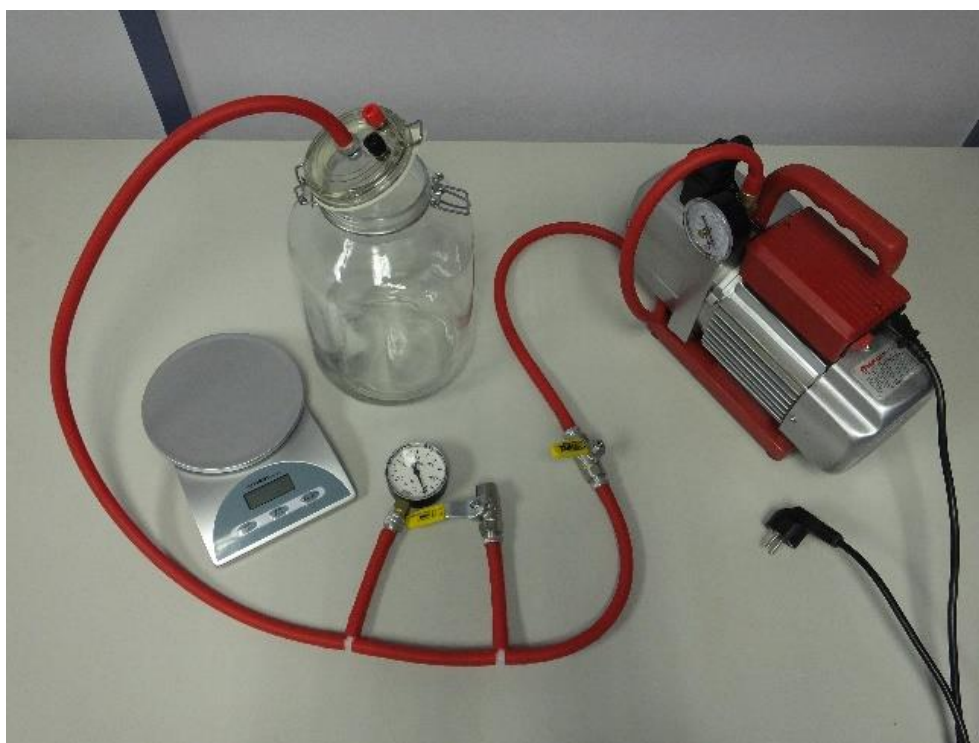
Slika 4.6.1. Eksperimentalni postav za vježbu vaganje zraka
