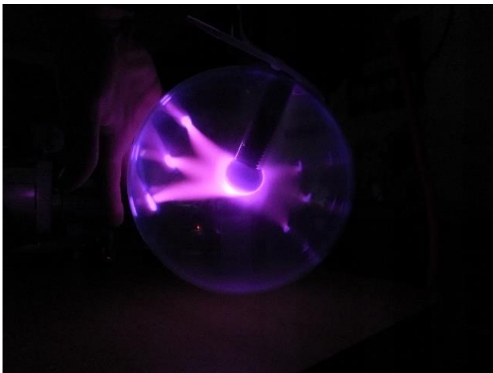
Slika 4.9.3. Plazma kod tlaka od dvadesetak mbar punjena zrakom
