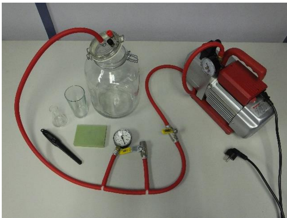
Slika 4.3.1. Eksperimentalni postav za vježbu voda u vakuumu
