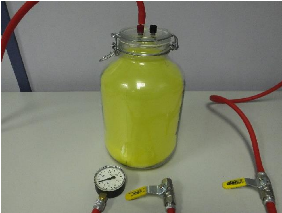
Slika 4.1.3. Balon u staklenci nakon vakuumiranja
